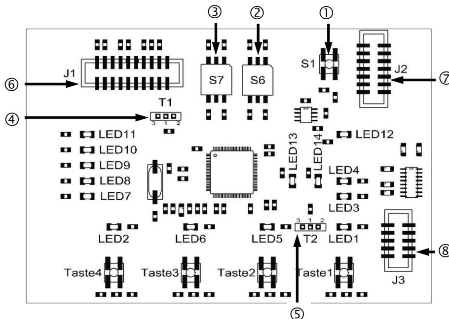
Die Tasten 1 bis 4 befinden sich auf der Vorderseite der Platine. Eine detaillierte Beschreibung ihrer Bediensystematik sowie der Anzeigeelemente ist dem Abschnitt [Funktionen der Bedien- und Anzeigeelemente](#) auf Seite 9 zu entnehmen.
